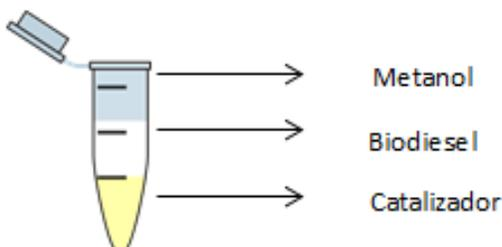
**Figura 20: Separación de fases de una muestra de reacción**
